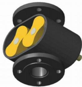
Fig. 2 Sezione di una pompa a lobi; si vedono i lobi che ruotando comprimono il gas
